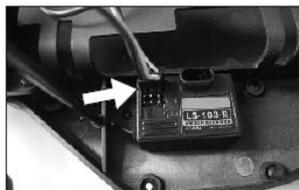
Stecken sie das ESC - Anschlusskabel in den Port 2.
