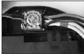
Bringen Sie das ESC , wie abgebildet, mit der Klebeseite an dem Chassis an.
