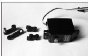
Legen sie die benötigten Teile: Servoarm, Servohalterung, Servogelenk und das Servo bereit.
