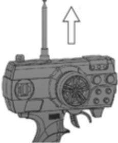
Ziehen Sie die Teleskopantenne vollständig heraus.
