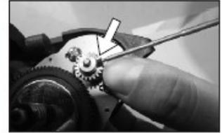
Setzen sie das Motorritzel auf die Motorwelle und ziehen sie die Schraube fest.
